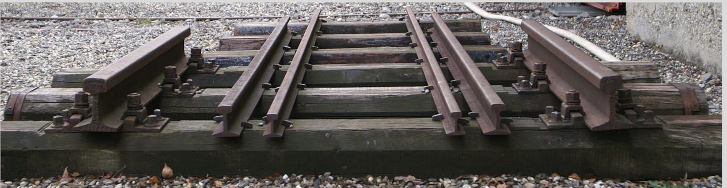
Bei Schienenfahrzeugen wird die Spurweite der Gleise angegeben, für die das Laufwerk ausgelegt ist. Der Abstand der Spurkränze wird als Spurmaß bezeichnet, die erforderliche Differenz als Spurspiel.
